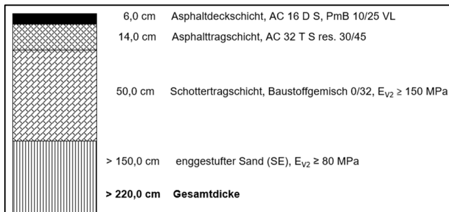
Bild 7: Aufbau der Verkehrsflächenbefestigung für die Deichquerung
