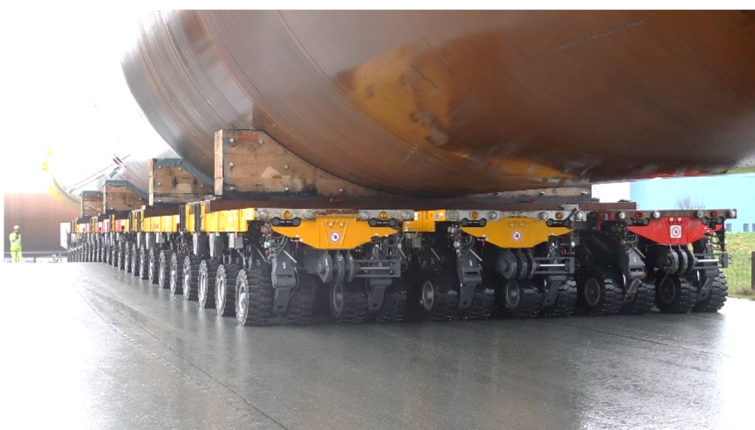
Bild 6: Transport eines Monopiles mittels SPMT über eine Deichquerung
