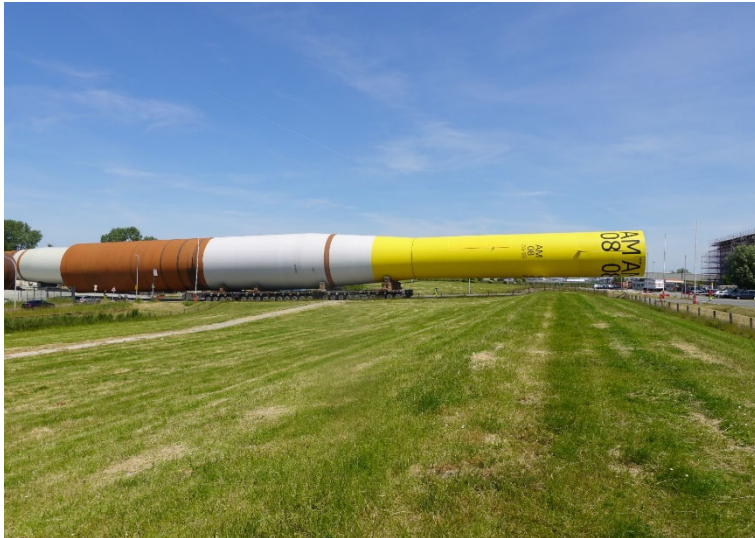
Bild 5: Transport eines Monopiles auf SPMT
